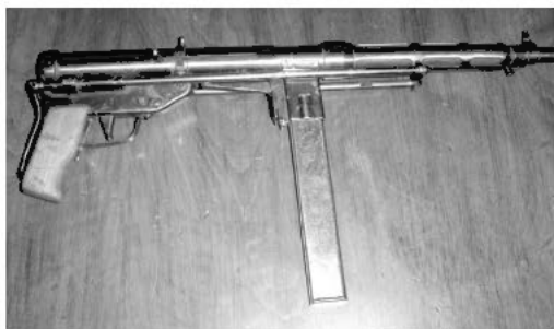
Un mitra TZ45 e, in evidenza, il sistema di sicura.
